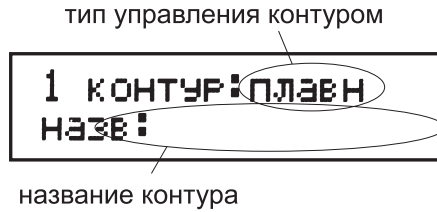
Рис.4.3. Экран ввода названия 1 контура
