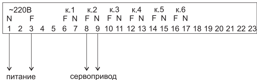
Рис. 3.1. Электрическая схема подключения сервопривода
