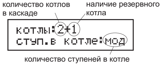
Рис.3.5. Экран дополнительных настроек котлов
