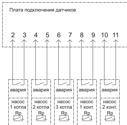
Рис. 2.7. Схема подключения некоторых датчиков технологической сигнализации
