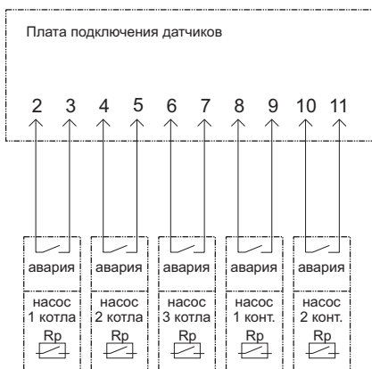
Рис. 2.7. Схема подключения некоторых датчиков технологической сигнализации
