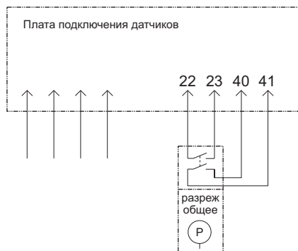
Рис. 2.8. Схема подключения датчика отсутствия разрезания дымохода
